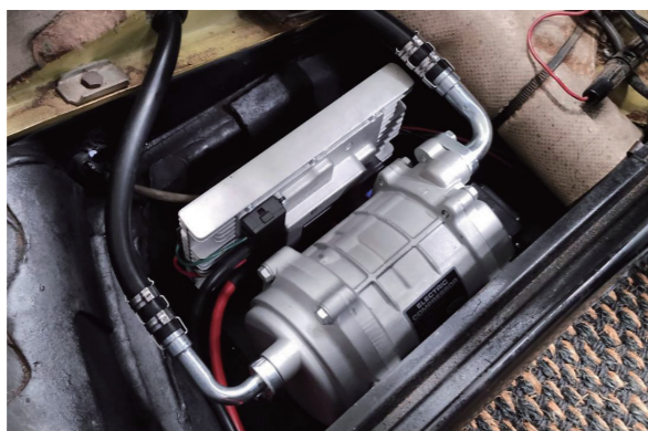
リアシート下(バッテリーの反対側)等にコンプレッサーを設置しスペースを有効活用!!
